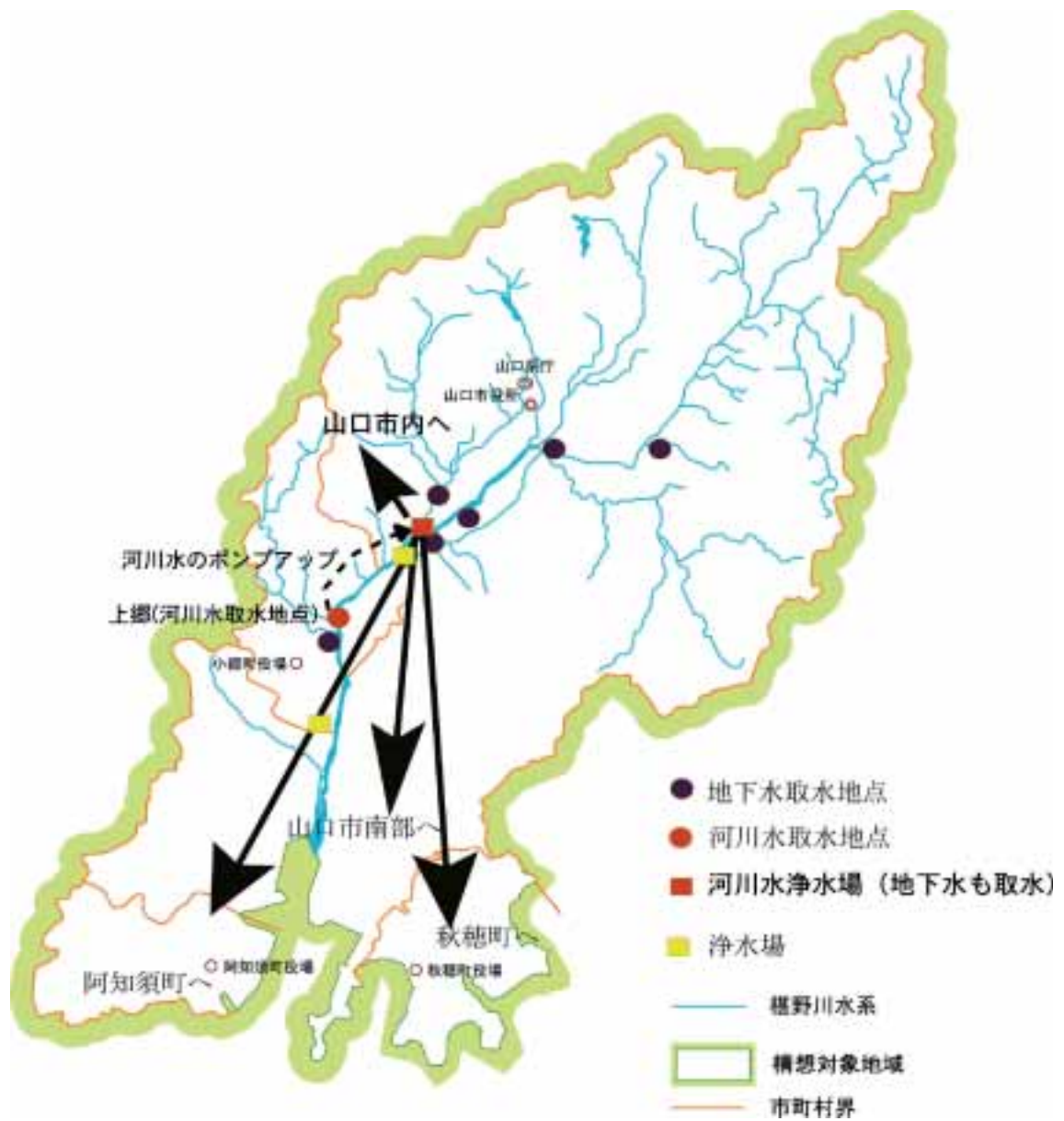
図 2-14 流域の水源と浄水場
